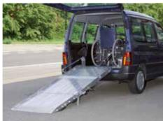
Eine weitere Variante ist die RRD. Sie ist drehbar und bietet vielfältige Einsatzmöglichkeiten. Wird die Rampe nicht benötigt, kann sie nach innen geschwenkt und mit einem Lagerbock fixiert werden.
