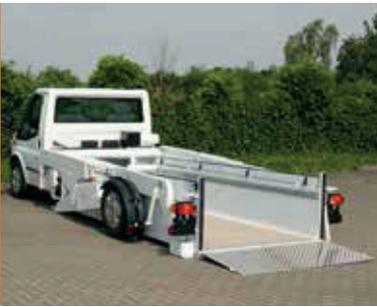
Mit dem überfahrbaren Rückladen aus Aluminium wird eine Verbindung zwischen Rampe und Fahrzeug geschaffen. Der überfahrbare Rückladen mit Warzenblechfahrfläche ist Bordwand und Überfahrbrücke in einem Element. Alternativ kann die Fahrfläche mit einem Korundbelag beschichtet oder eloxiert werden.
