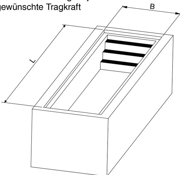
Verschiedene Grubenvarianten mit den entsprechenden Abdeckungen. Im Auftragsfall benötigen wir die in den Zeichnungen markierten Maße sowie die Länge der Grube und die benötigte Tragfähigkeit.
